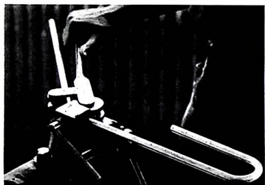
Bild 11. Einfache Biegevorrichtung zum Anfertigen von Faltdipolen
