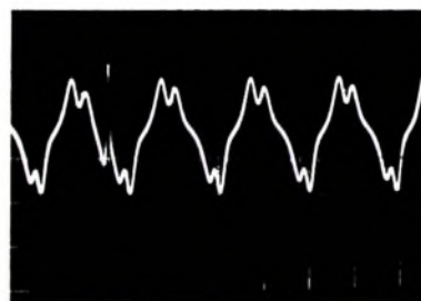
Bild 3. Wiedergegebene Kontrollspur mit Schneideimpuls
