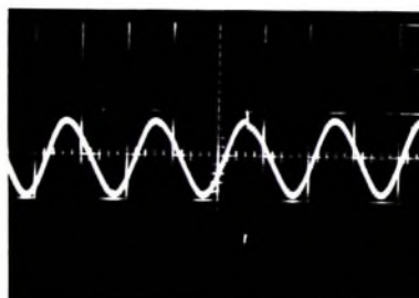
Bild 2a. Kontrollspur mit Schneideimpuls während der Aufzeichnung
